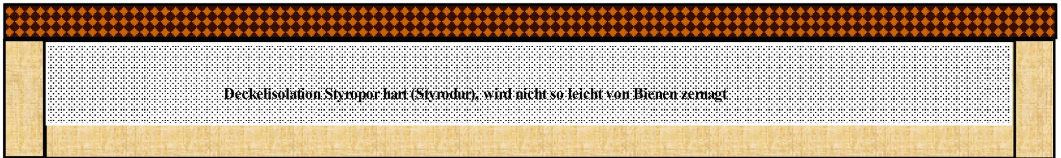
Deckelisolierung Styropor hart (Styrodur), wird nicht so leicht von Bienen zernagt
